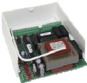
Central eletrónica com regulador de força, paragem suave (abrandamento de velocidade), temporizador de fecho. Detecção de obstáculos com inversão de movimento.
